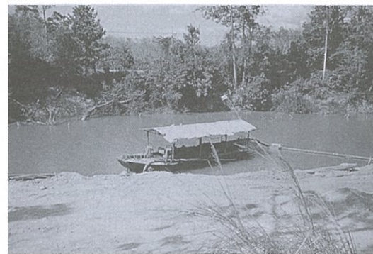
เรือดูดทราย สาเหตุที่ทำให้ตลิ่งแม่น้ำทรุดตัวและพังในที่สุด
