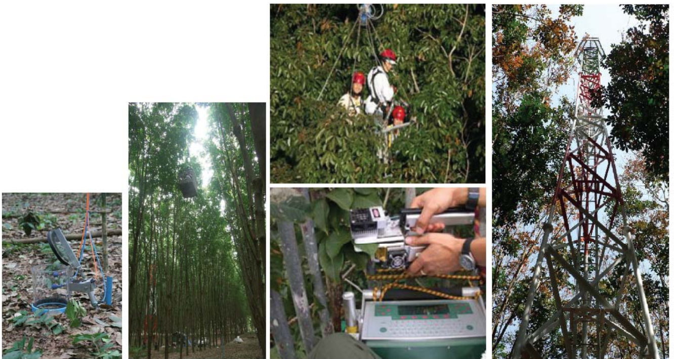
รูปที่ ๒๓ การศึกษาสมดุลของการแลกเปลี่ยนคาร์บอนไดออกไซด์ น้ำ และพลังงาน ของยางพารา ด้วยเทคนิคสัสมพันธ์ เอ็ดดี้ ที่ศูนย์วิจัยยางพารา จังหวัดฉะเชิงเทรา ซึ่งเป็นงานความร่วมมือระหว่างมหาวิทยาลัยเกษตรศาสตร์ กรมวิชาการเกษตร และสถาบันวิจัย CIRAD ประเทศฝรั่งเศส
