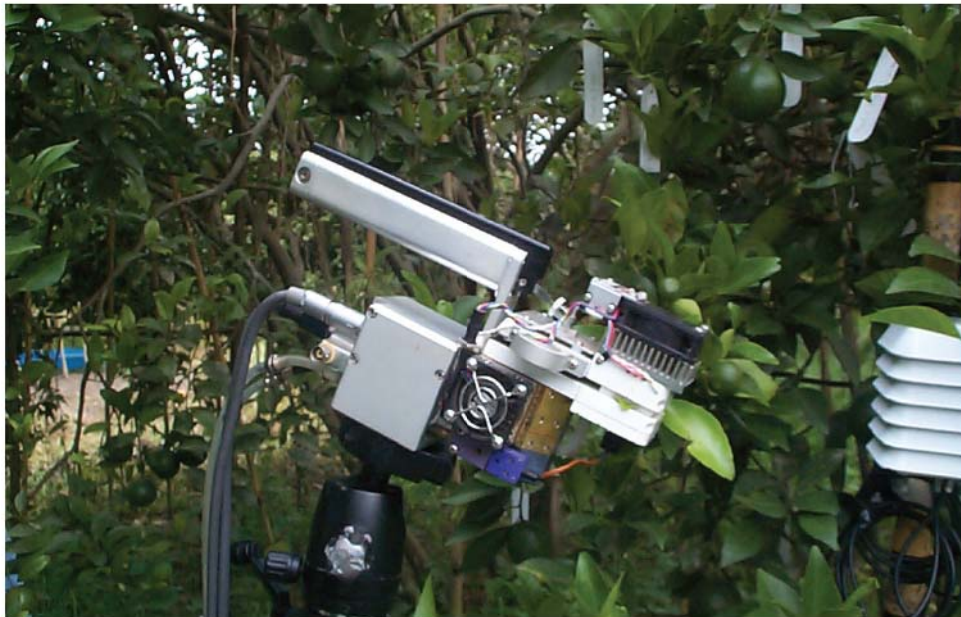
รูปที่ ๒๑ การศึกษาอัตราการสังเคราะห์ด้วยแสงของพืชด้วยเครื่องวิเคราะห์แก๊สอินฟราเรด
