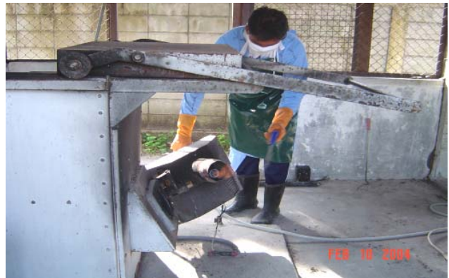
รูปที่ ๔ การจุดหัวเผาแบบแก๊ส ที่โรงพยาบาลตากใบ. ม.ป.ป.. นวัตกรรมปรับเปลี่ยนระบบการเผาขยะติดเชื้อ โรงพยาบาลตากใบ
