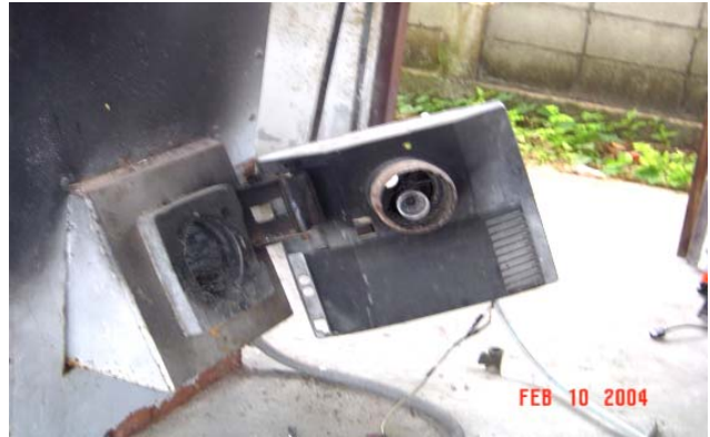
รูปที่ ๓ หัวเผาแบบแก๊สกับเรือนเผาแบบเดิม
