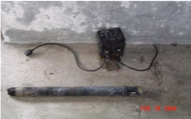
รูปที่ ๑ หัวเผาระบบน้ำมันเชื้อเพลิง
